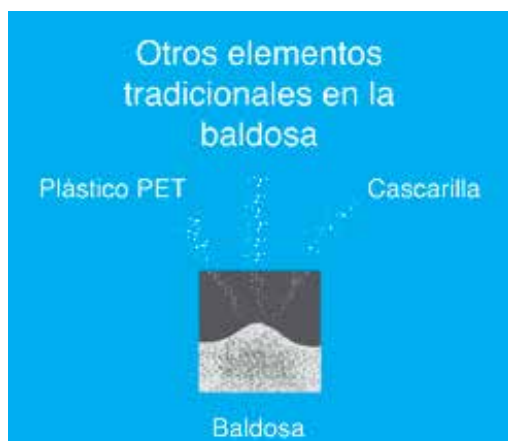
Figura 1. Proceso de mezcla de los componentes para la placa de la baldosa.
