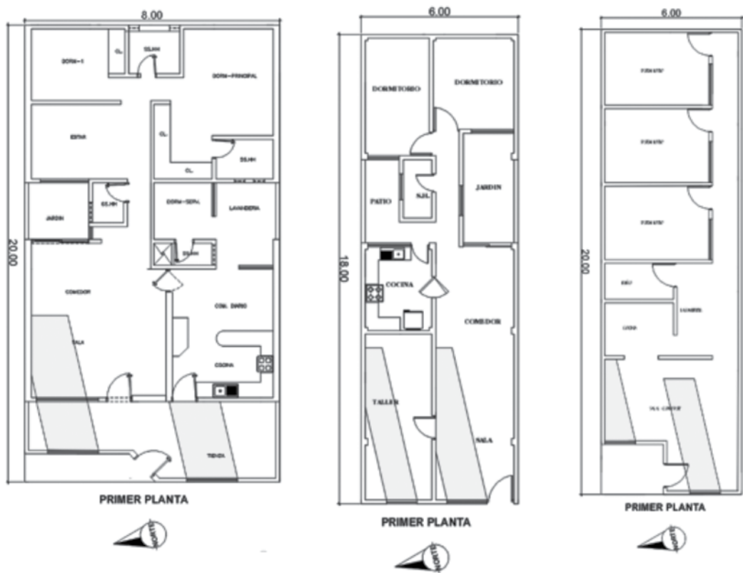
Vista 1: Distribución de viviendas del Distrito Piura, Castilla y 26 Octubre, con características semejantes, ventilación deficiente (muy mala 66.23%, mala 6.02%), ventilación de un ambiente a otro 47.12%, orientación muy mala 58.64%, con gran impacto solar (incidencia solar muy mala 43.19% y mala 16.23%), sin medios de protección adecuados para la incidencia solar
